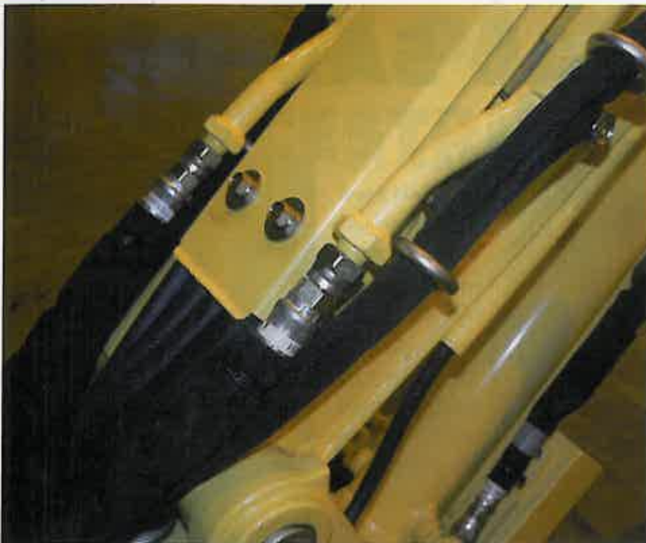
Passaggio curato e protetto dei flessibili
