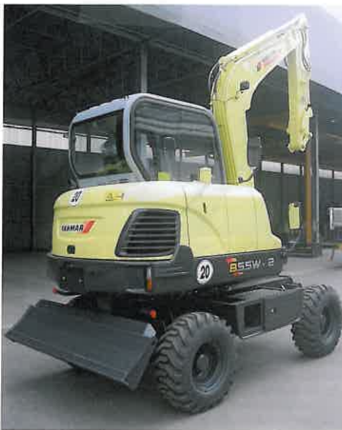
Selnen neuen, 5,5 t schweren Mobilbagger B55W-2 verlieh Ammann Yanmar viel Motor- und Hydraulikleistung, höhere Grabkräfte und Fahrgeschwindigkeit
