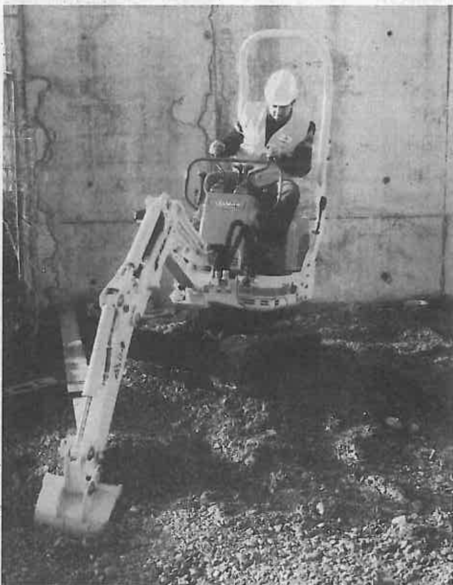
Der SV08-1 ist serienmäßig mit einem Rops-Überrollbügel ausgestattet. Dieser kann nach hinten umgeklappt werden, um auch durch niedrige Durchfahrten zu passen. Foto: Ammann-Yanmar
