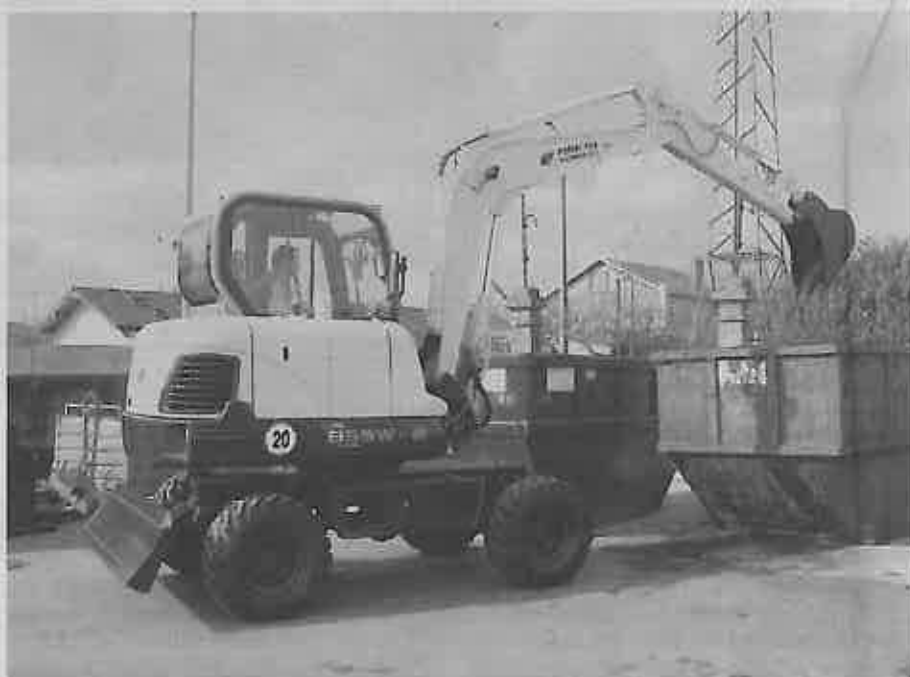
Der neue Mobilbagger B55W-2 von Ammann-Yanmar mit einem Betriebsgewicht von 5550 kg kombiniert die Vorteile einer Kompaktmaschine (Breite: 1920 mm) mit guten Leistungsdaten.
