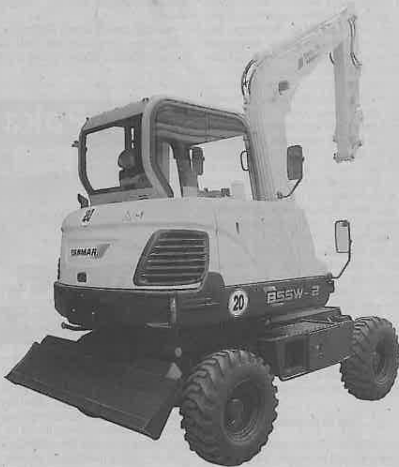
Der leistungsfähige Radbagger B55W-2 von Ammann-Yanmar komplettiert das Angebot an Minibaggern in der Klasse von 5 bis 6 t.
