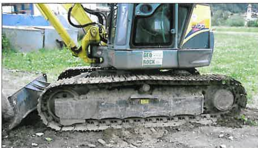
■ Le doti di stabilità dell'escavatore si possono riassumere nella particolare lunghezza del carro (3.070 mm) e nel sistema Victas® di incremento della superficie portante
