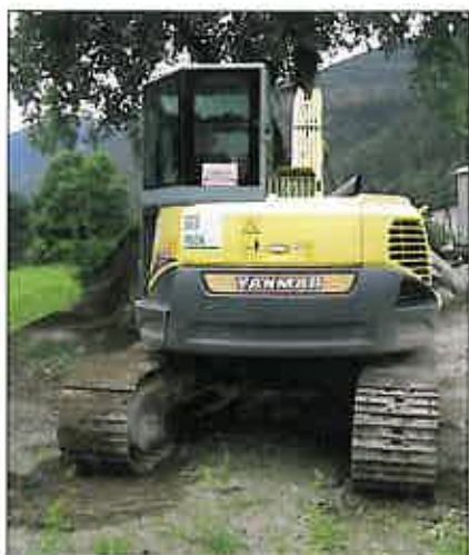
■ Le doti di stabilità dell'escavatore si possono riassumere nella particolare lunghezza del carro (3.070 mm) e nel sistema Victas® di incremento della superficie portante
