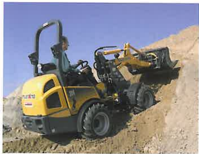
De machinist heeft extra goed zicht op de AL 306, doordat de hefcilinders midden op de mast staan.
