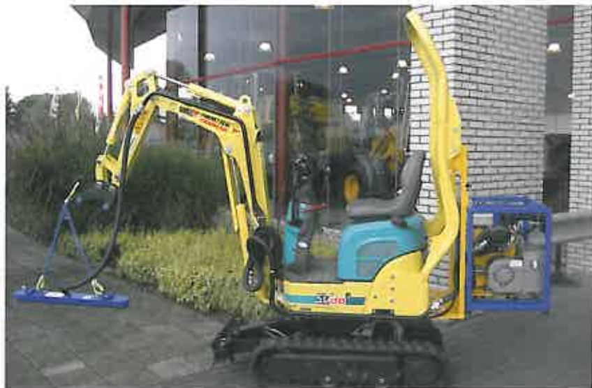
De SV 08, de op   n na kleinste Yanmar uit de semi-vio serie, is uitgerust met vacu mklem vooral bij straatmakers in trek.
