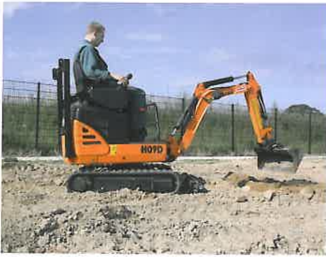
Net als de grote jongens beschikt de nieuwe H 09 D, een één-tonnertje, over servobediening.
