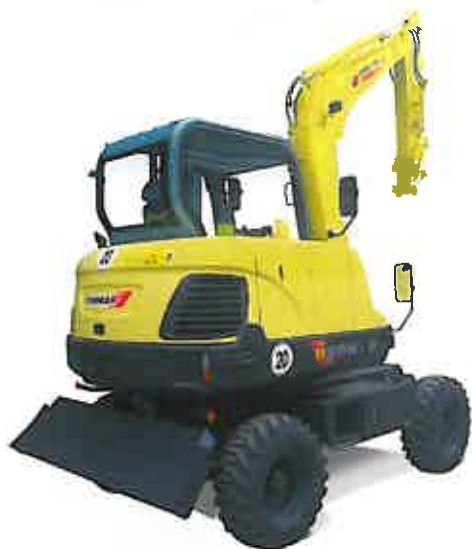
De vernieuwde Yanmar B 55 W heeft onder andere standaard een langere giek dan zijn voorganger.
