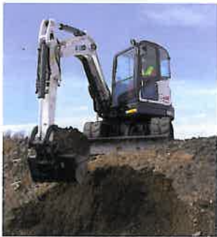
La cabine ROPS offre un espace comparable à celui des cabines des pelles de taille classique.
