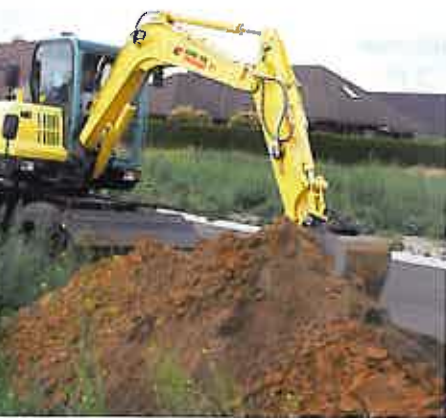
La profondeur de fouille de la B55W-2 peut atteindre les 5 495 mm.
