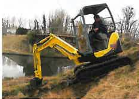
La mini-pelle SV 20 a deux lignes hydrauliques.
