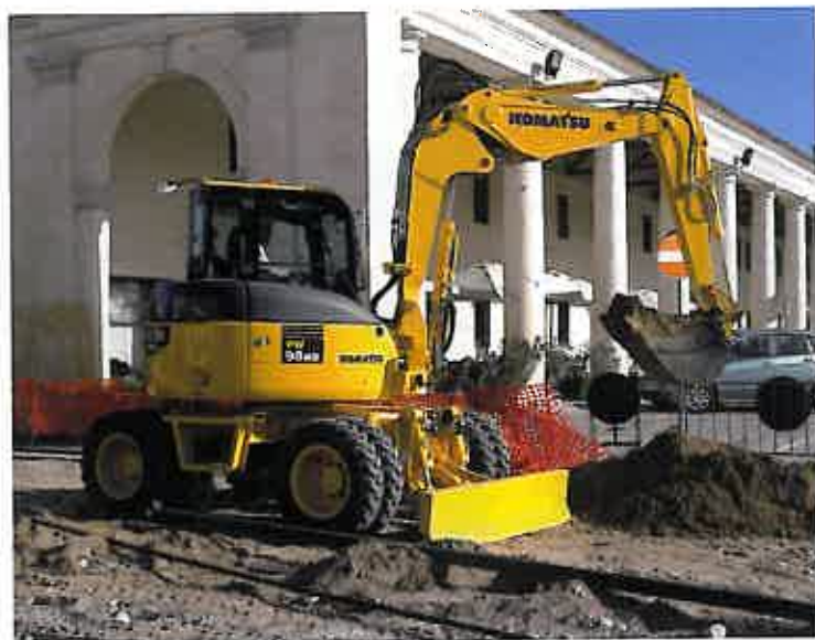
La PW98MP-6 présente deux capots pour un accès rapide et aisé sur tous les points de maintenance.
