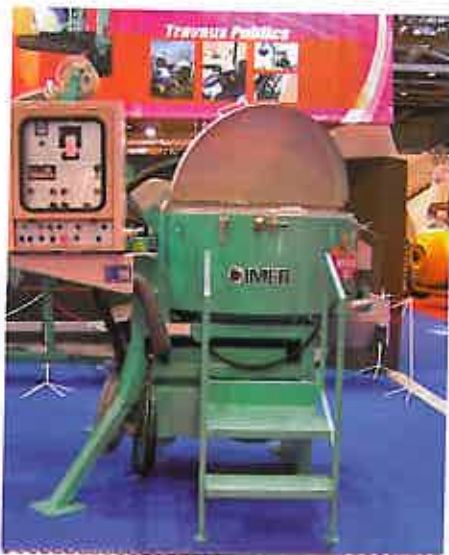
Aucune maçonnerie n'est nécessaire pour les fondations avec la EKO 601. Cette mini-centrale permet de mélanger toutes sortes de mortiers et bétons plastiques.
