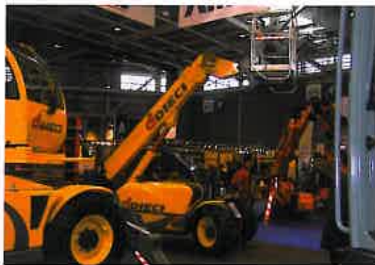
On peut désormais apprêter l'Apollo 25,6 d'une nacelle ou d'un godet. Ce qui conduit l'élévateur d'Ammann à encore plus de modularité.
